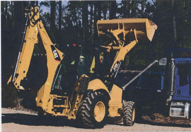
Caterpillar offre un choix de timonerie à vérin de cavage unique ou de chargeur industriel (IT) pour convenir aux exigences de vos applications. Les commandes de chargeur IT offrent une commande proportionnelle par levier unique et une modulation précise des outils de travail hydrauliques. Une molette au pouce permet d'actionner des fonctions hydrauliques auxiliaires telles que celles du godet tous-travaux sur les machines IT.
