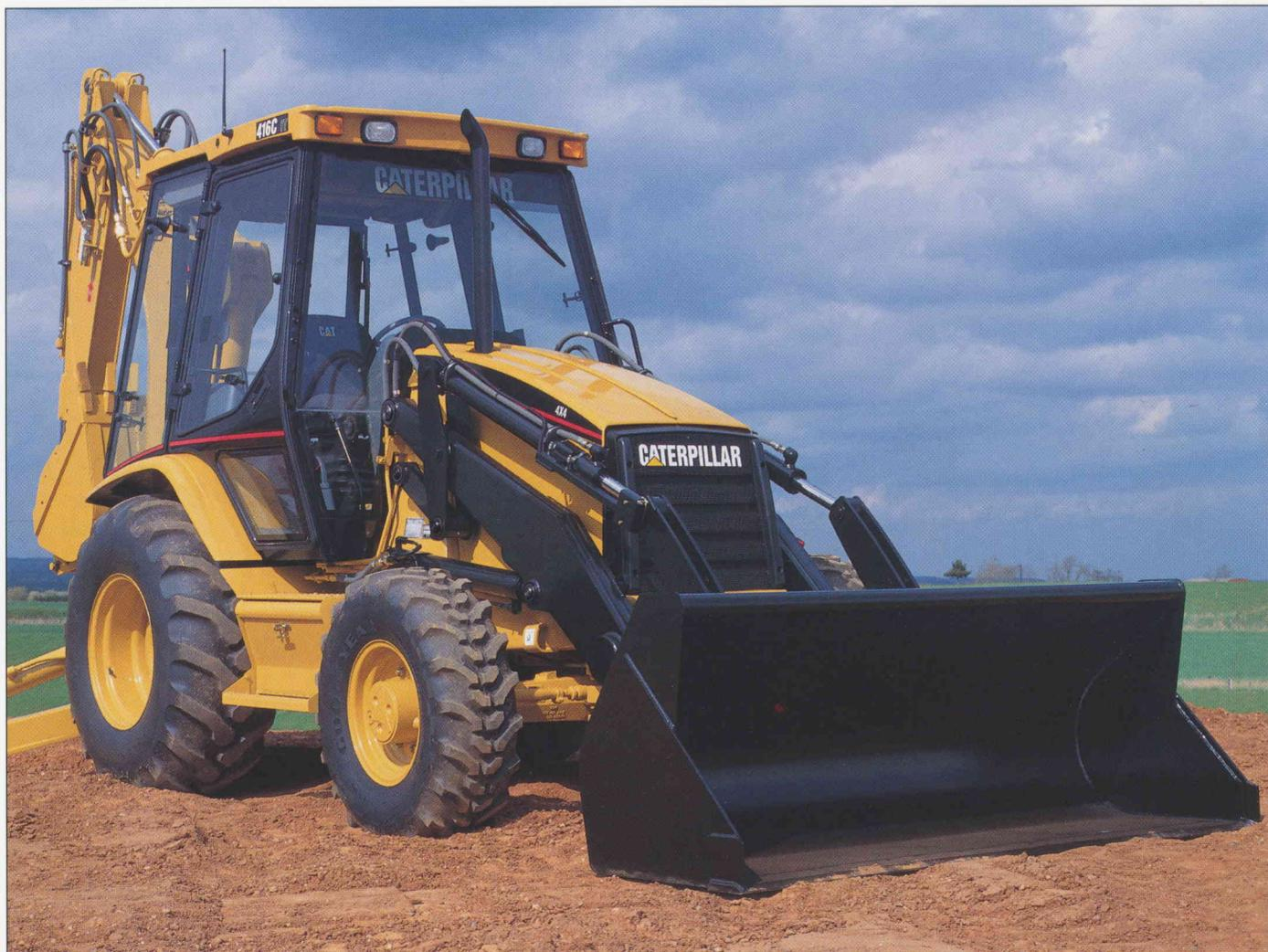
**Chargeur.** Dans le cas des machines de la série C, un chargeur frontal avec porte-outils intégré (IT) est offert en option. Ce type de chargeur permet d'optimiser la capacité de levage et la puissance d'arrachement, tout en rendant possible le levage parallèle, fonction très pratique pour le chargement et la manutention. Le système de rappel automatique à l'angle de cavage facilite les choses et permet d'améliorer le cycle de travail. Le
