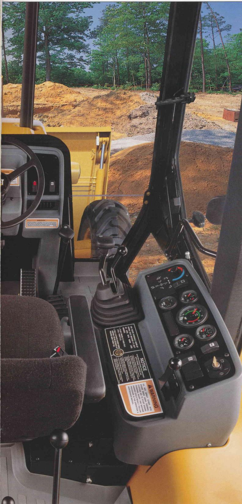
**Les commandes.** La 416C établit une nouvelle norme en matière de conduite, de précision et d'ergonomie. Le tableau de bord est convivial, les commandes judicieusement placées. Le système hydraulique à débit variable (avec détecteur de charge) permet de régler le débit et la pression en fonction du travail à effectuer. L'opérateur étant moins sollicité, il se fatigue moins, ce qui se traduit par un gain de productivité.
