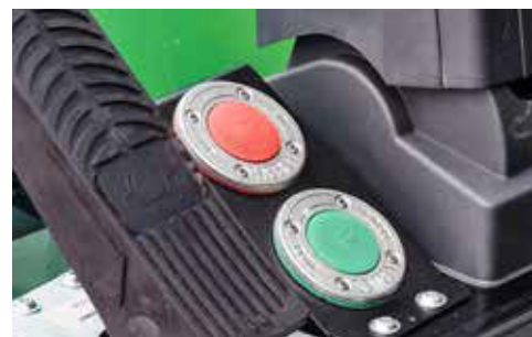
Pédale confortable du réglage en hauteur progressif de la cabine
