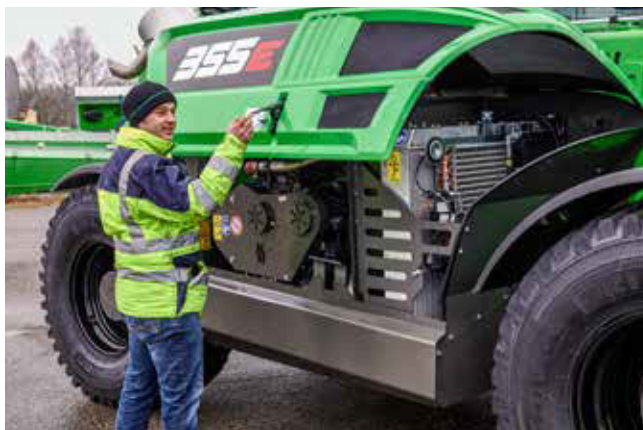
Ouverture rapide du compartiment moteur, accès aisé aux composants.
