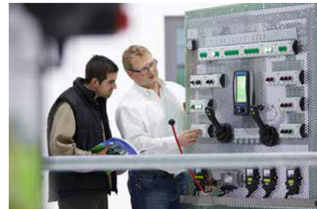
Panneau de commande et élément d'interface opérateur-machine, y compris l'affichage des codes d'erreur.
