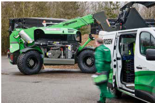
Ouverture rapide du compartiment moteur, accès aisé aux composants.
