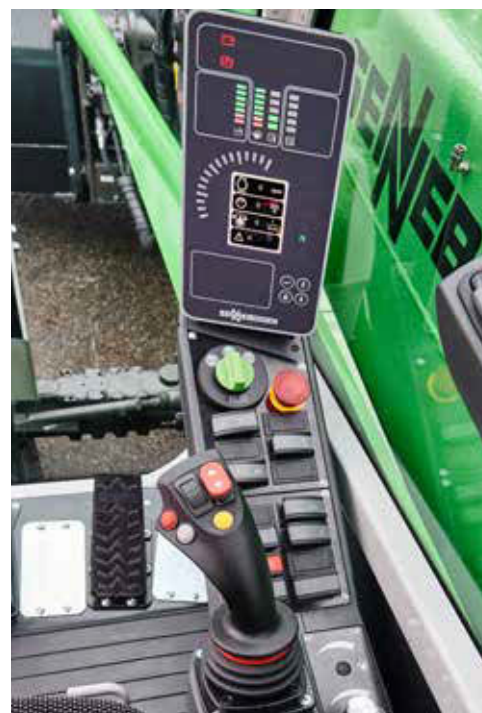
Console et éléments de commande fixés au siège
