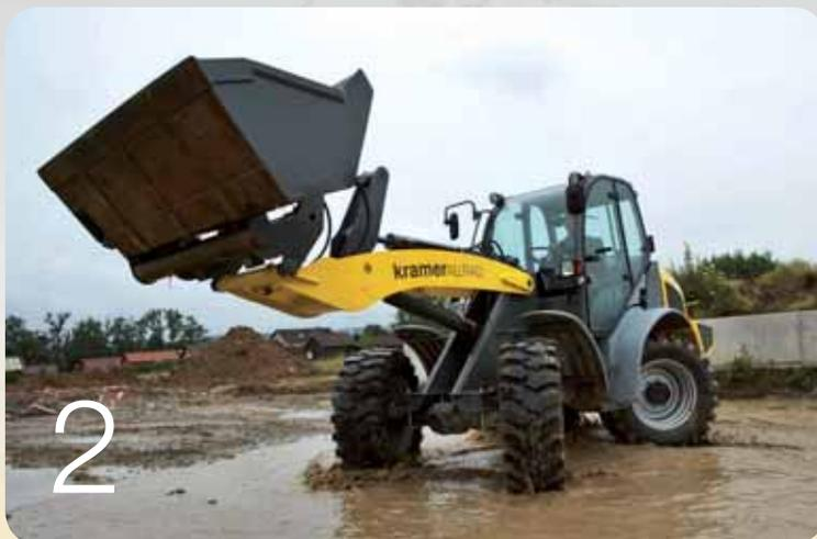
**Il nostro baricentro resta costante: telaio monoblocco, integrale quattro ruote sterzanti e manovrabilità fino al punto di battuta.**
