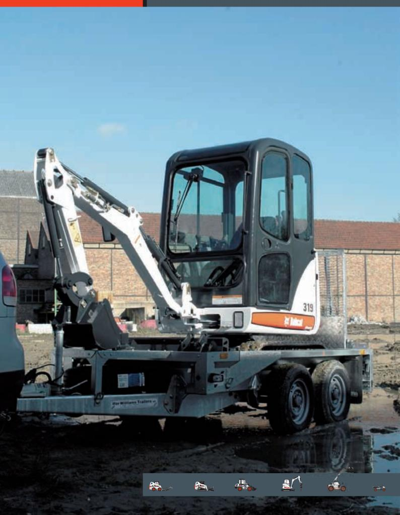
Lame de remblayage de 980 mm Chenilles en caoutchouc de 200 mm Circuit hydraulique auxiliaire
