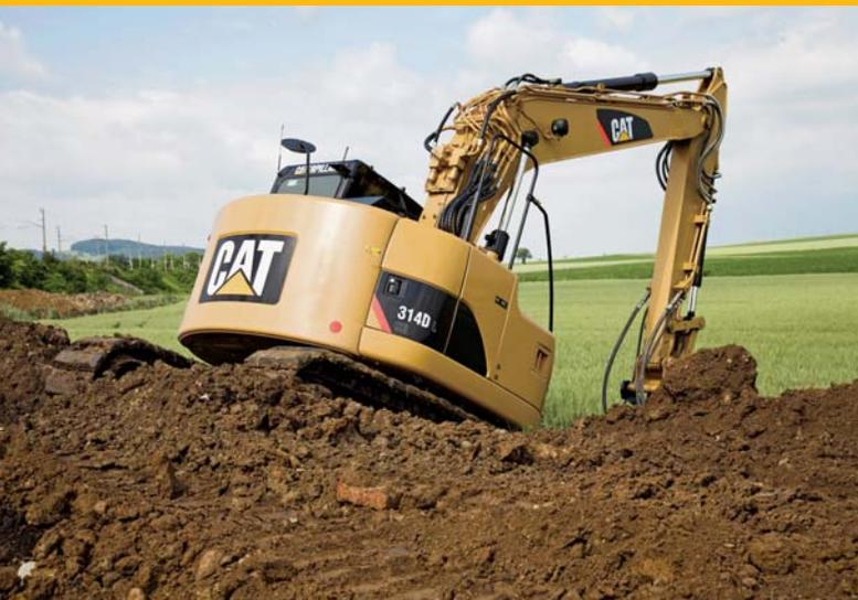
Der Cat® Motor C4.2 mit ACERT™-Konzept sorgt für beste Leistung und entspricht den EU-Abgasvorschriften Stufe IIIA. In Verbindung mit der integrierten Elektronik werden durch das ACERT-Konzept die Abgase beim Verbrennungsprozess verringert. Durch seine ausgezeichnete Leistung und höheren Hydraulikdruck steigert der C4.2 Ihre Produktivität und senkt die Betriebskosten pro Tonne bewegter Masse.
