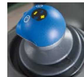
Kreuzschalthebel für das 1. und 2. Hydrauliksteuergerät und den Frontlader, inklusive der Bedienung des 3. und 4. Kreises.
