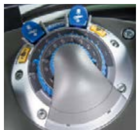
Krafthebelbedienmodul (EHR) mit Zapfwellenbedienung.
