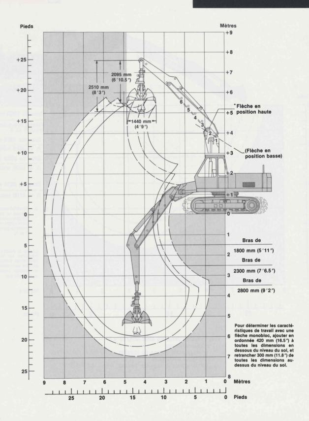
Si la flèche est montée en position basse, les profondeurs de fouille augmentent de 420 mm/16.5" et les hauteurs de vidage diminuent de:
