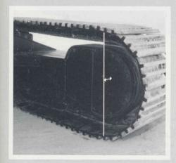
Réducteurs latéraux compacts, protégeant les moteurs de chaîne, les disques de frein et les canalisations hydrauliques. Ces organes trouvent place à l'intérieur de l'enveloppe formée par les patins de chaîne (y compris les patins standard de 500 mm/19.7 "). Protections pour moteurs de chaîne superflues.
