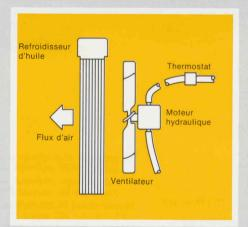
Le refroidisseur d'huile hydraulique, qui est indépendant du ventilateur du moteur, assure le refroidissement requis sous des températures ambiantes élevées. Le ventilateur du refroidisseur est entraîné hydrauliquement et commandé par thermostat. Un témoin s'allume sur le panneau d'instruments quand le ventilateur tourne à la vitesse maximale.
