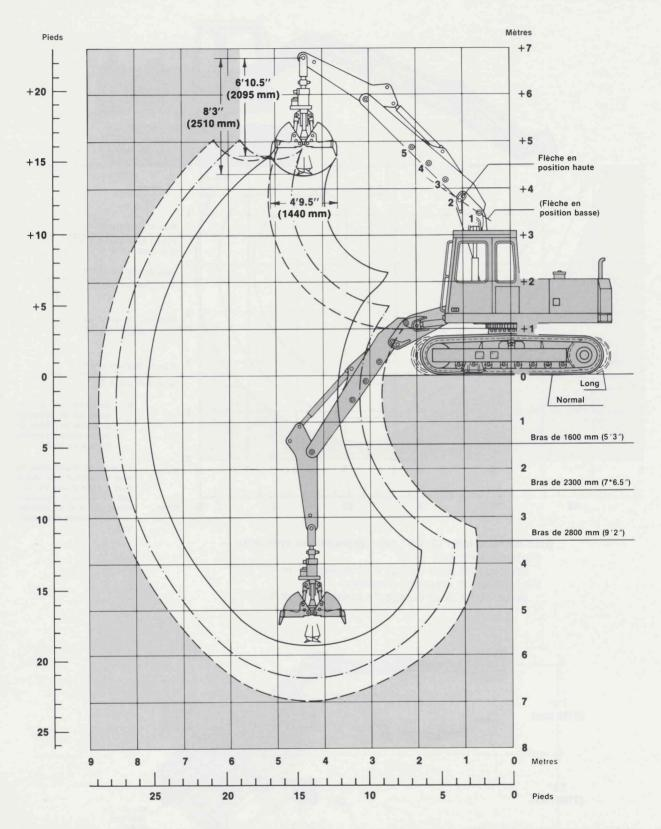
Le montage de la flèche en position basse se traduit par une augmentation des profondeurs de creusage de 533 mm/21.0" et une diminution des hauteurs de vidage
