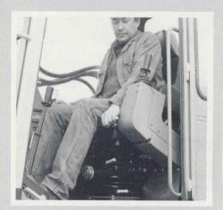
En relevant **l'accoudoir gauche** pour accéder au siège, on neutralise toutes les fonctions hydrauliques, sauf les circuits déjà sollicités à ce moment précis.
