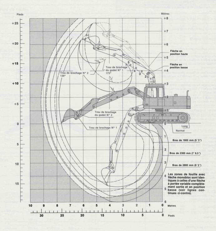
Les godets normaux comportent chacun deux trous de brochage correspondant à des conditions de travail différentes. Le trou de brochage N° 1 donne un angle de creusage large pour une moindre force, le trou de brochage N° 2 un angle de creusage réduit avec une force plus importante.
