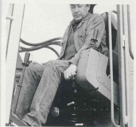
En relevant l'**accoudoir gauche** pour accéder au siège, on neutralise toutes les fonctions hydrauliques, sauf les circuits hydrauliques déjà sollicités à ce moment précis. Pour la mise en marche du moteur, l'accoudoir doit être en position relevée.
