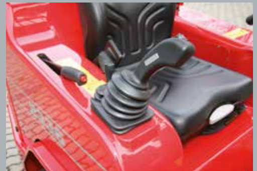
Der leicht nach innen gedrehte Joystick erleichtert die Bedienung.
