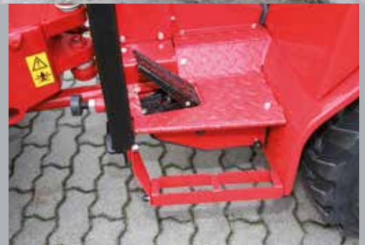
Der Aufstieg ist durch die niedrige Bauweise noch komfortabler.
