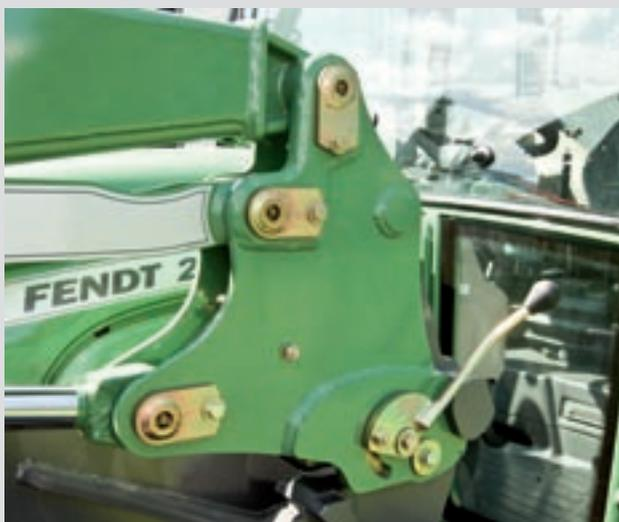
Con el Fendt CARGO-Lock montará y desmontará el cargador frontal CARGO en su 200 Vario todavía más rápido y con mayor facilidad. El bloqueo semiautomático le ahorra tener que utilizar pernos de bloqueo, que a menudo funcionan con dificultad. Al mismo tiempo, el sistema ofrece una seguridad en el trabajo óptima, ya que el cargador frontal se bloquea de inmediato tras la entrada.
