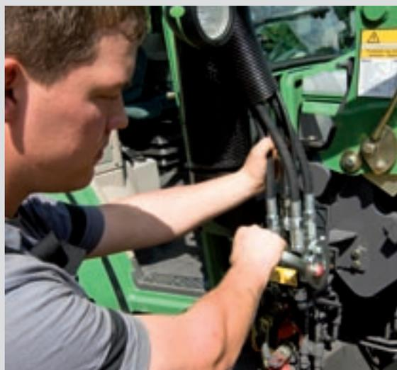
El acoplador múltiple sirve para conectar todos los conductos hidráulicos y eléctricos, en el lado del cargador frontal incluso bajo presión. De este modo, el cargador frontal CARGO se monta y desmonta en un abrir y cerrar de ojos.
