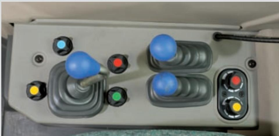
La palanca monomando en cruz permite manejar de forma muy precisa la primera y la segunda válvula.
