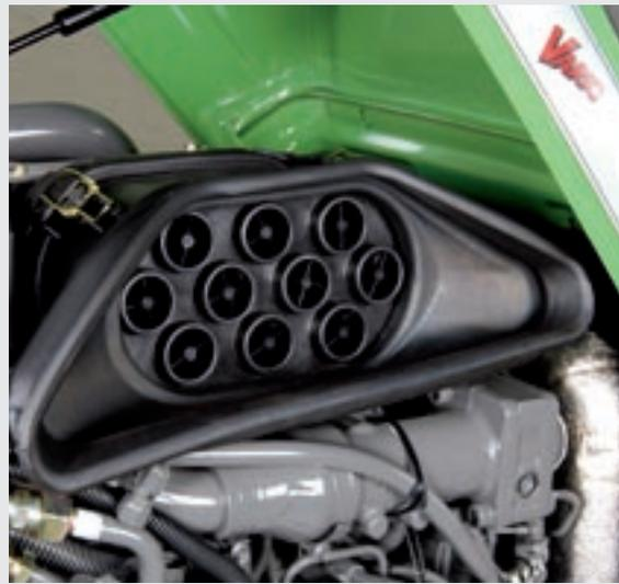
El filtro de aire con preseparador de ciclón presenta un rendimiento máximo a pesar de las estrechas condiciones de montaje que se dan en los tractores compactos.
