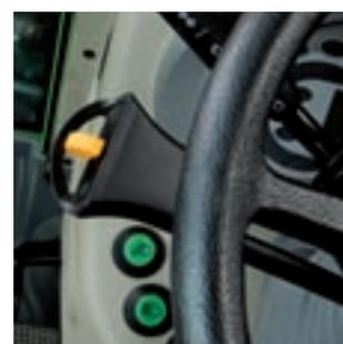
La palanca de inversión de la marcha permite cambiar cómodamente la dirección de conducción con la mano izquierda.
