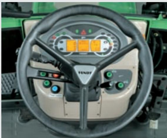
El volante, regulable en altura e inclinación, permite que cualquier conductor pueda tener siempre la posición ideal al sentarse.
