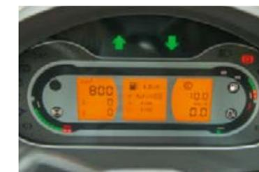
Einfach umstellbar: Lassen Sie sich in der Multifunktionsanzeige anzeigen was Sie für Ihre Arbeit benötigen, z. B. den aktuellen und den durchschnittlichen Kraftstoffverbrauch oder die bearbeitete Fläche.
