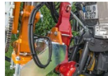
Immer dabei: die im Frontkraftheber integrierte Anbauplatte bietet eine stabile und sichere Basis für schwere Frontgeräte.
