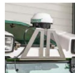
Positionsbezogene GPS-Lenksysteme erreichen im Fendt 200 V/F/P Vario eine Genauigkeit von bis zu 2 cm.
