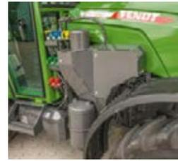
□ Sauber integriert ist die Zweikreis-Druckluftbremsanlage.
