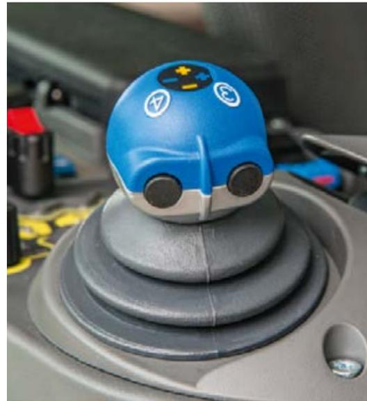
■ Den dritten und vierten Steuerkreis betätigen Sie bequem vom elektrischen Kreuzschalthebel als Taster oder Schalter.
