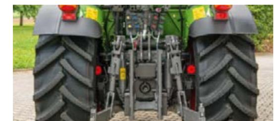
In der P-Variante steht Ihnen ein vollwertiger Kat2 Kraftheber zur Verfügung. Für alle Varianten gilt: alle Anschlüsse sind übersichtlich angeordnet und gut erreichbar.
