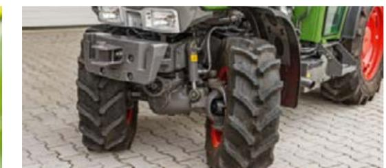
Mit der VarioActive Funktion erreichen Sie mit nur einer Lenkradumdrehung den maximalen Lenkeinschlag.
