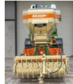
Über zwei Hydraulikzylinder lassen sich die Unterlenker nach rechts und links verstellen und führen das Heckgerät exakt in der Zeile. In der Schwimmstellung ist freies Pendeln möglich.
