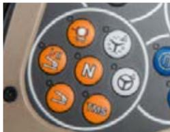
Die VarioActive Überlagerungslenkung und die Spurführung aktivieren Sie bequem an der Lenkradkonsole.
