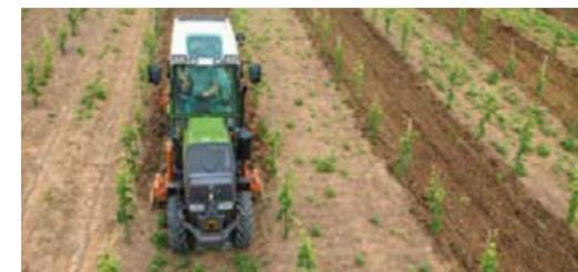
Der kleinste Spurkreisradius beträgt nur 3,2 m, je nach Bereifung. Das merken Sie sofort am Reihenende wenn Sie ohne Richtungswechsel in die übernächste Zeile wechseln können.
