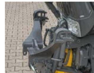
Die Unterlenker der Fronthydraulik lassen sich mit wenigen Handgriffen kompakt einklappen.
