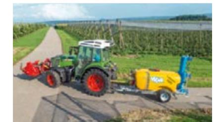
Effiziente Kombination von Arbeitsgängen. Mit der 540E/750 Frontzapfwelle fahren Sie den Mulcher mit Arbeitsdrehzahl, die Spritze im Heck und der Schlepper arbeiten dennoch mit reduzierter Motordrehzahl.
