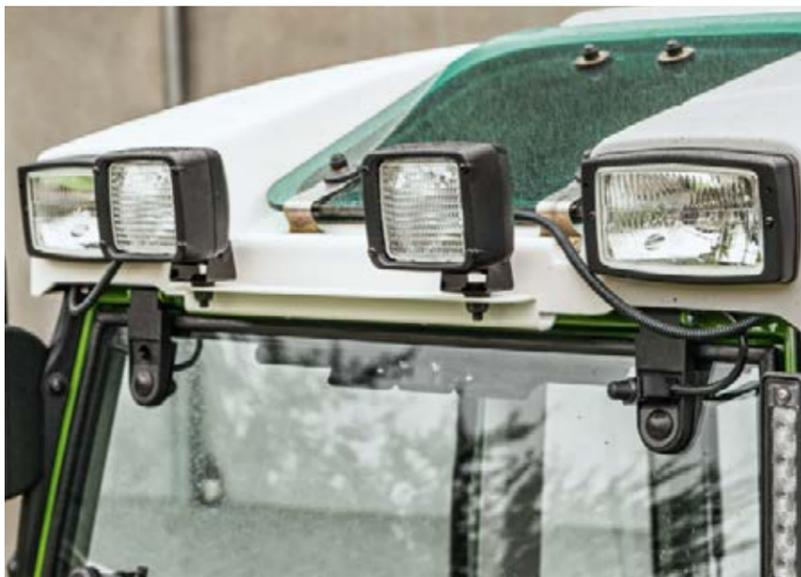
□ Bei Ausführung mit Zusatzscheinwerfer können vorne zusätzlich zwei Arbeitsscheinwerfer angebaut werden.
