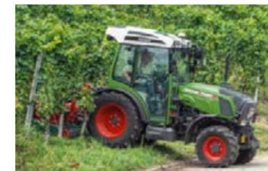
Die Zapfwellen arbeiten unabhängig von der Fahrgeschwindigkeit. So fahren Sie z. B. beim Mulchen bei dichtem Bestand langsam und bei wenig Bestand schneller, stufenlos, ohne schalten oder Kraftflußunterbrechung.
