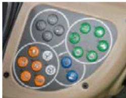
Im Armaturenbrett rechts bedienen Sie schnell und einfach per Klick die Vielfachanzeige, die Komfortschaltung für Allrad, Differentialsperrung und Vorderachsfederung sowie das Traktor-Management-System TMS.
