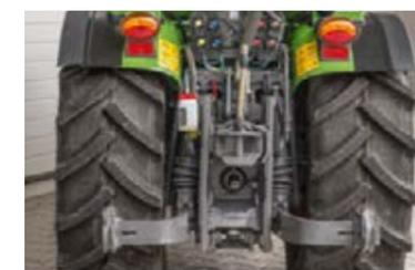
Der Pendelkraftheber der V/F Varianten ist vor der Hinterachse angelenkt. Die weit verstellbaren Unterlenker bzw. Fanghaken lassen eine einfache Anpassung an jedes Gerät zu.
