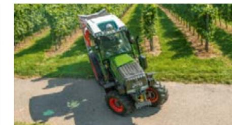
Die schlanke Wespentaille erlaubt einen hohen Lenkeinschlag bis 58° und in Kombination mit der VarioActive Lenkung eine überragende Wendigkeit.
