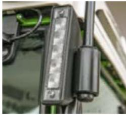
□ Die Blink- und Positionleuchten sind sauber in die A-Säule integriert.
