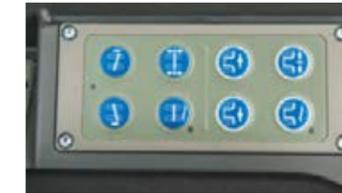
Die Seiten- und Neigungsverstellung des Pendelkrafthebers steuern Sie per Tastendruck, ebenso wie das Pendeln und Sperren. Mit der Neigungsverstellanzeige finden Sie immer die passende Einstellung.
