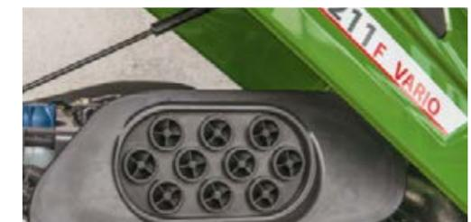
Hochleistungsluftfilter für hohe Abscheideleistungen unter schwierigen Bedingungen.
