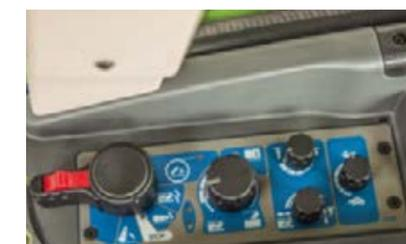
Im EHR-Bedienfeld lässt sich der Heckkraftheber übersichtlich einstellen. Mit der Automatikfunktion kann die Betätigung auf den Multifunktions-Joystick gelegt werden.
