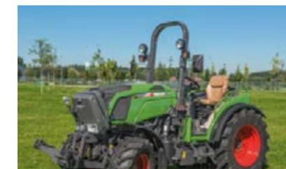
Für den Einsatz in Gewächshäusern oder unter besonders engen Bedingungen bietet Fendt Varianten ohne Dach und mit Überrollbügel an.
