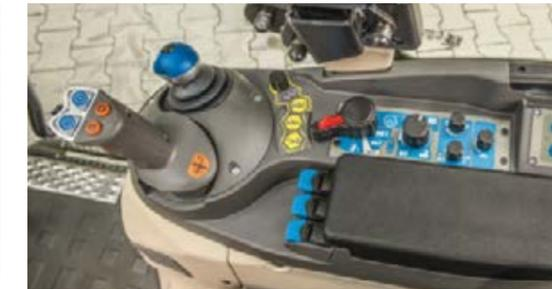
Mit der Stop&Go-Funktion am Wendeschalthebel verzögert der Fendt V/F/P Vario bis zum Stillstand und beschleunigt in die Richtung, in die der Taster betätigt war.
