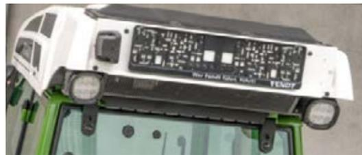
□ Mit den LED-Arbeitsscheinwerfern am Dach hinten behalten Sie die Anbaugeräte im Blick.
