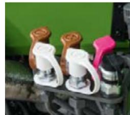
□ Die hydraulische Querverbindung vermeidet lose Schläuche die über die Haube liegen.
