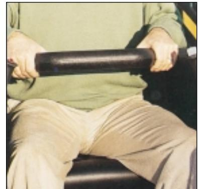
Der nach oben schwenkbare Sicherheitsbügel betätigt automatisch die Feststellbremse und unterbricht den Hydraulikkreislauf.
