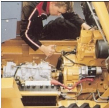
Die Kipbare (1825 B) oder verschiebbare Kabine (1840/1845C) erlaubt einen schnellen und ungehinderten Zugang zu Motor, Getriebe und Hydraulik.
