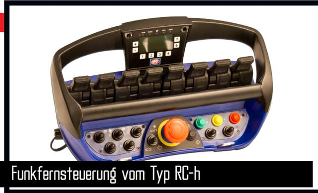
Die Funkfernsteuerung von HMF bietet alle Vorteile und Möglichkeiten für Funkfernbedienung wesentlicher Kran- und Sicherheitsfunktionen im HMF RCL-Sicherheitssystem. Der Kranbediener kann sich im ganzen Arbeitsbereich frei bewegen und sich jederzeit optimal im Verhältnis zur Hebeaufgabe platzieren. Unabhängig von einer festen Bedienstelle (Steuerung vom Boden) bietet die Kranbedienung über das Senderpult viele Bedienmöglichkeiten.
