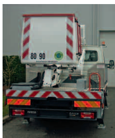
Stabilisateurs en H sur PL Outriggers in H position on heavy truck
