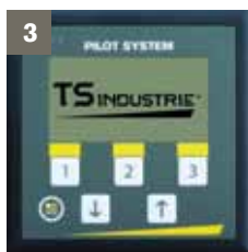
3 - PILOT SYSTEM. Centralisation du pilotage et du contrôle de la machine 3241.
