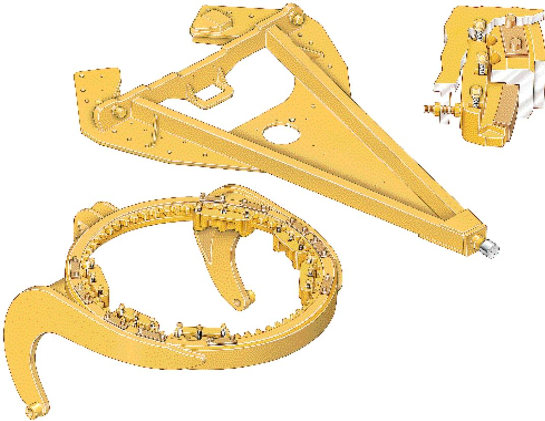
**Robuste Bauweise.** Um eine hohe Festigkeit zu erreichen besteht der A-förmige Scharzugrahmen aus einer aufwendigen Kastenprofil-Konstruktion. Die Rahmenunterseite ist maschinell bearbeitet, damit sich eine nahezu spielfreie Einstellung für präzise Planierarbeiten ergibt. Der einteilige, geschmiedete Drehkranz mit induktionsgehärteten Zahnköpfen wird mit Hilfe von sechs Gleitschuhen exakt geführt und verkraftet höchste Dauerbelastungen.
