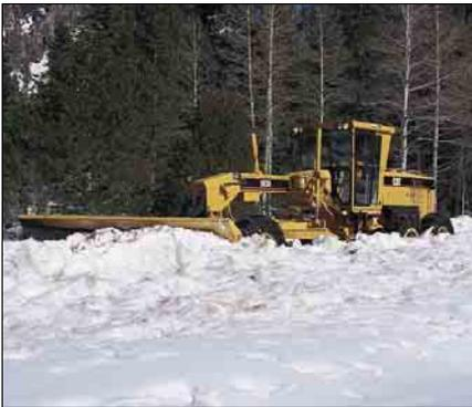
**Traktion.** Bei schlechten Untergrundverhältnissen – beispielsweise in Schnee, Morast und Sand – garantiert der Allradantrieb nicht nur einen exzellenten Vortrieb, sondern verbessert zugleich das Spurverhalten der Maschine.
