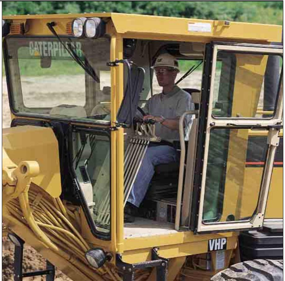
**Bedien- und Kontrollelemente.** Sämtliche Steuerhebel und Schalter sind griffgünstig in den Lenkrad- und Schalthebelkonsolen sowie in der rechten A-Säule der Kabine angeordnet. Instrumente und Kontrollleuchten befinden sich direkt im Blickfeld des Fahrers.
