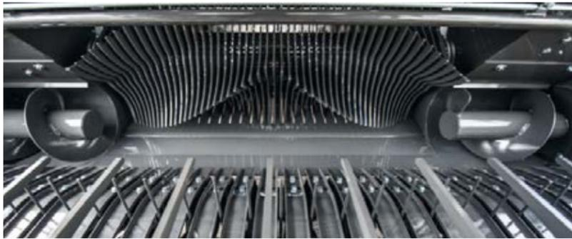
Durch den geringen Abstand zwischen Pick-Up und Rotor erfolgt die Futterübergabe schonend und zuverlässig. Durch seine V-Form füllt er die Presskammer gleichmäßig für Ballen in Bestform.
