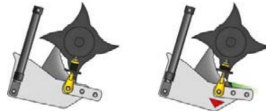
Das Entlastungssystem Flexcontrol verhindert Blockaden zuverlässig.
