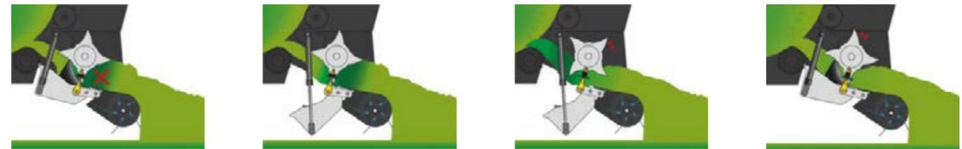
Im Fall einer Verstopfung wird der hintere Teil des Schneidbodens um 500 mm abgesenkt.
