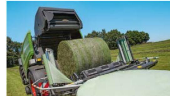
Der sanfte Antrieb des Wickelrings über hydraulisch angetriebene Gummierollen erreicht schnell die richtige Geschwindigkeit für einen gleichmäßigen Wickelvorgang.
