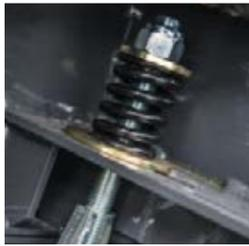
Die Flexcontrol-Feder nimmt die Lastspitzen aus dem vorderen Teil des Kanalbodens auf und verhindert somit Blockaden.
