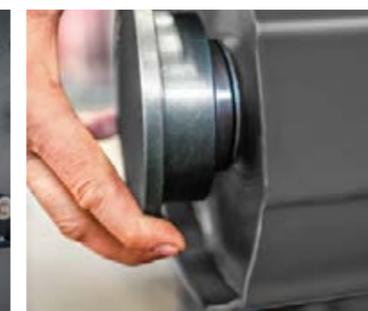
Die 50 mm messenden Lager an den Walzen sind für höchste Belastungen ausgelegt.
