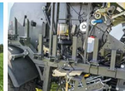
Die Folie geht Ihnen mit den 12 Foliensaltern unterwegs nicht mehr aus. Setzen Sie ganz einfach die Rollen mit Verpackung auf die einzelnen ausklappbaren Zinken.
