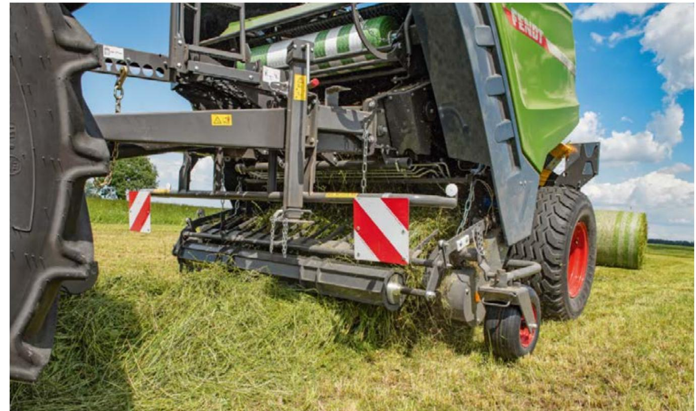
Den Rollniederhalter stellen Sie bequem über zwei Ketten an der Seite ein und regeln damit den Gutfluss zum Rotor optimal.
