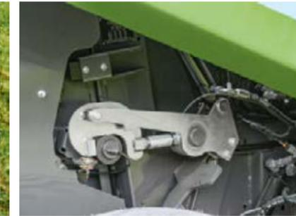
18 PowerGrip Walzen starten die Rotation immer zuverlässig und sorgen für gleichmäßige Verdichtung.
