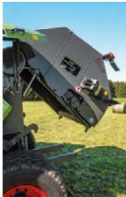
Ein Dorn an der Heckklappe sorgt dafür, dass sie auch beim Einsatz in Hanglagen zuverlässig geschlossen wird.
