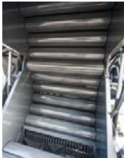
3 Rippen der PowerGrip Stahlwalzen sind ständig in Kontakt mit dem Ballen und sorgen für eine zuverlässige Rotation.
