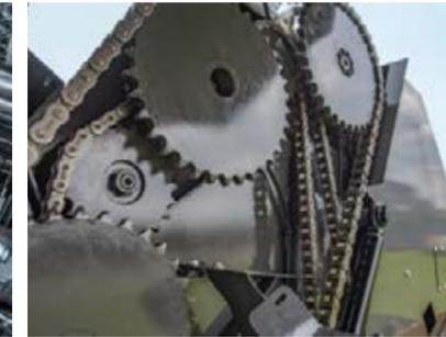
Das Freilauf-Kettenrad schützt den Antriebsstrang im Falle einer Rotorblockade vor Schäden.
