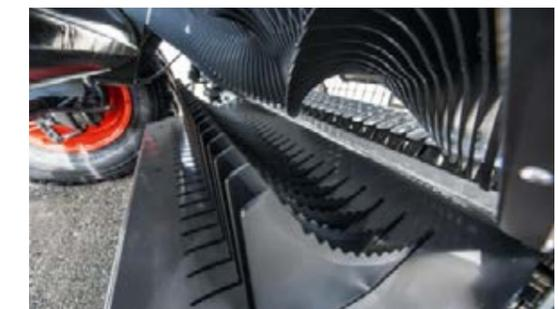
Im Topmodell 130 F Xtra steht Ihnen eine hydraulische Messergruppenschaltung von 0, 12, 13 und 25 Messern zur Verfügung.
