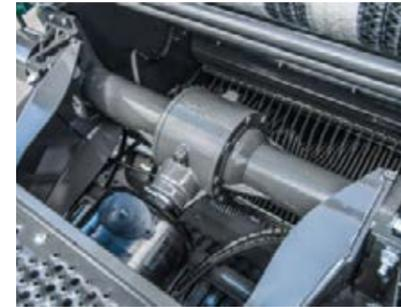
Der Kammerantrieb ist aufgeteilt und erfolgt über zwei Ketten.
