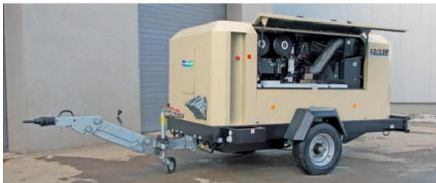
As portas com grande raio de abertura e os drenos centralizados contribuem para a simplicidade de manutenção do modelo 12/150, onde todas as áreas foram pensadas para facilitar a inspeção, a manutenção e a reparação.
