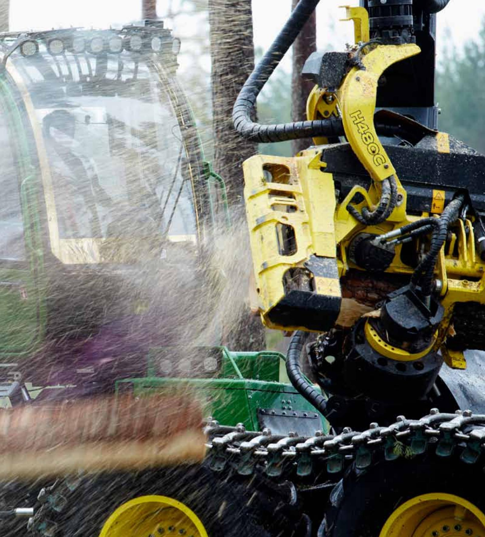
John Deere verfügt über eine große Auswahl an produktiven und langlebigen Harvesteraggregaten, die je nach Einsatzzweck mit zwei oder vier Vorschubwalzen erworben werden können.
