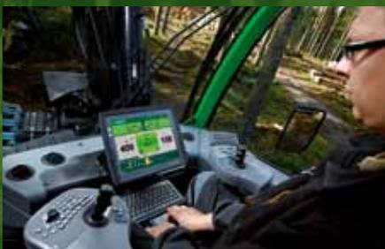
TimberMatic H-12 ist ein bedienerfreundliches Automatisierungssystem, das die Produktion, die Holzmessung und die Steuerung der Basismaschine sowohl optimiert als auch vereinfacht. Der neue PC, HPC14, hilft ebenfalls dabei, den anspruchsvollen Anforderungen der Forstbranche gerecht zu werden.
