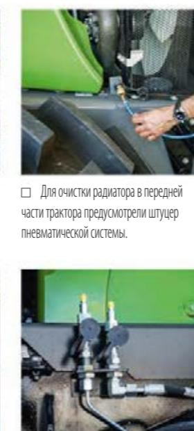
■ Для некоторого рабочего оборудования доступна полностью пневматическая система.
