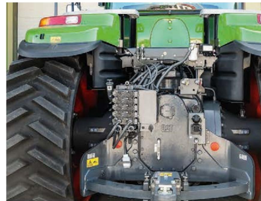
Благодаря такому тяговому брусу с диапазоном отклонения 28° в каждую сторону можно максимально точно задавать рабочее положение оборудования.
