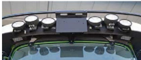
■ Ксеноновые фонари рабочего освещения NightBreaker превосходно освещают окружающее пространство. По заказу трактор может быть укомплектован светодиодными фонарями.
