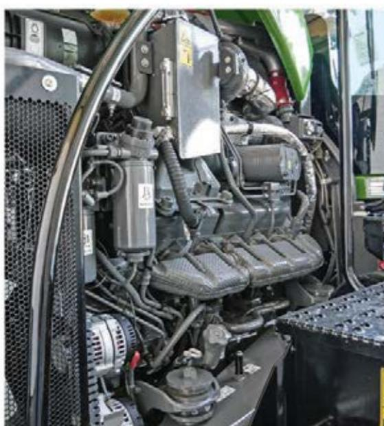
■ 12-цилиндровый двигатель AGCO Power отличается плавным ходом и удобством при техническом обслуживании.
