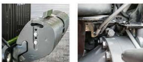
■ На передней части рамы можно закрепить противовес массой 990 кг.
