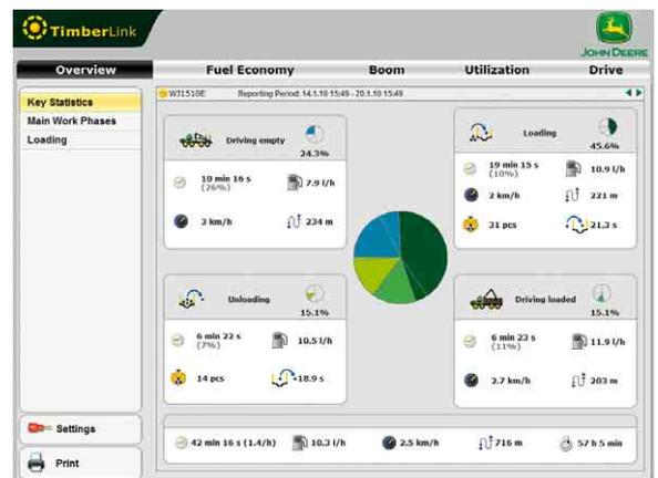
Le système de contrôle TimberLink F-09 se base sur les durées et la consommation de carburant au cours de quatre phases de travail différentes.
