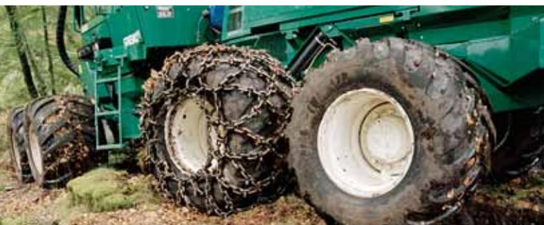
Восемь колес харвестера в лесу всегда имеют преимущества, обеспечивая устойчивость в процессе валки и отличную проходимость. Опция подъема тандемной тележки позволяет вписываться в малый радиус поворота между деревьями при промежуточных рубках.
