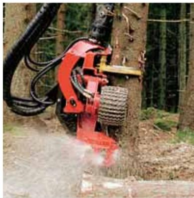
Харвестер Greta1050 H оснащается очень надежной головкой SP 551 LF, работающей на принципе пониженного трения и имеющей ряд патентованных технических решений.
