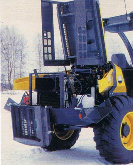
Alle Seitenverkleidungen sind leicht zu öffnen. Die darunter liegenden Teile sind einfach zu erreichen. Da der Harvester kompakt und niedrig ist, ist eine Treppe für diese Arbeit nicht erforderlich.
