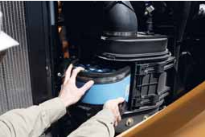
Il filtro dell'aria si smonta facilmente e la polvere viene aspirata ed espulsa nello scarico
