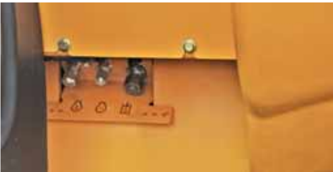
Scarichi dei fluidi raggruppati sul lato sinistro
