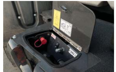
Elektrisch öffnende Motorhaube und Batterie-Hauptschalter. Anschlüsse für den Fremdstart.
