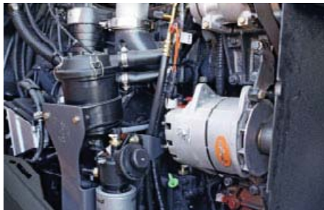
Der Kraftstoff-Filter und die Schaugläser sind von beiden Seiten zugänglich. Alle anderen Filter befinden sich hinter dem rechten Aufstieg
