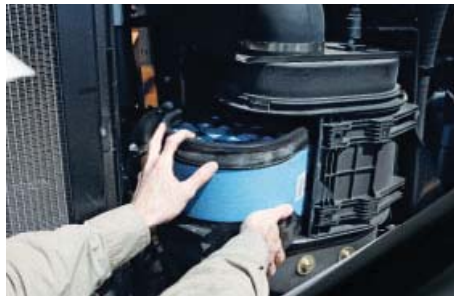
Der Luftfilter lässt sich problemlos ausbauen und Staub wird durch den Auspuff angesaugt und ausgeworfen.
