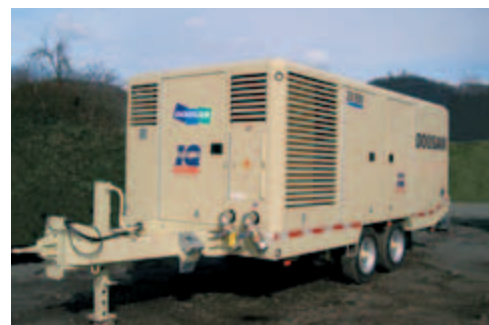
25/330 su assale tandem ad alta velocità opzionale e dotato di sistema IQ opzionale.
